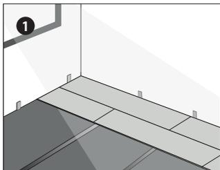
Die Empfohlene Verlegerichtung ist längs zur Hauptlichtquelle. Die größtmögliche zusammenhängende Verlegetfläche beträgt 10 m in Richtung Breite und 10 m in Längsrichtung. Zu Wänden, größeren Flächen und Räumen müssen passende Bewegungsfugen berücksichtigt werden.
