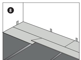
Das nächste vollständige Produkt wird wie zuvor erst längsseitig flach eingewinkelt und noch vor dem Einrasten strinseitig dicht an das vorherige Produkt geschoben. Drücken Sie es langsam herunter, sodass es längsseitig und stirnseitig spürbar einrastet. Dieses Vorgehen kann für den gesamten Raum fortgeführt werden.
