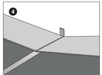
Die Produkte der ersten Reihe werden zuerst auf der kurzen Stirnseite verbunden. Es wird in einem Winkel von 25° angesetzt und eingeschwenkt. Achten Sie darauf, dass diese auf der Stirnseite exakt gerade ausgerichtet sind.
