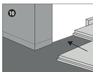
Müssen Sie einen Ausschnitt für eine Holzstütze vornehmen, dann legen sie das Produkt gegen die Stütze und kürzen dieses entsprechend der Höhe des Produktes. Achten Sie auch dort auf ausreichend Bewegungsfugen von ca. 5 mm.
