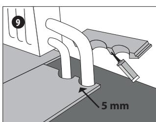
Müssen Sie einen Ausschnitt für Heizkörperrohre, Pfeiler, Trennwände oder sonstiges vornehmen, dann achten Sie auch dort auf einen Abstand von ca. 5 mm zu den Bauteilen.
