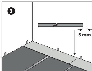
Entfernen Sie bei der ersten Produktreihe die Feder zu der Wand. Lassen Sie zur Wand einen Abstand von ca. 5 mm.
