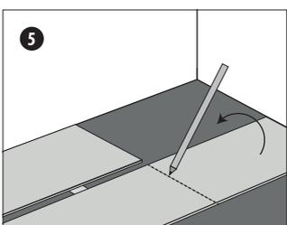
Markieren Sie das letzte Produkt der Reihe und markieren Sie dieses auf der Rückseite. Schneiden Sie es nun so zu, dass die erste Reihe gelegt ist. Das übrig gebliebene Stück wird den Anfang der zweiten Reihe bilden.
