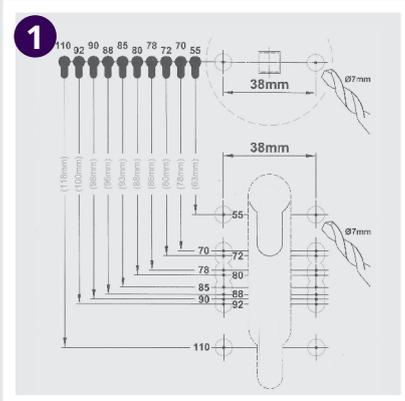
1 Stecke den Vierkant in die dafür vorgesehene Öffnung der Tür, richte die Schablone daran aus und zeichne die Bohrlöcher auf beiden Seiten des Türblattes an.
